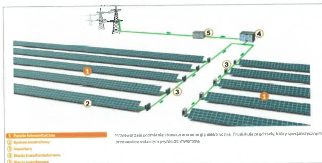
Rycina 1. Schemat działania elektrowni fotowoltaicznej
